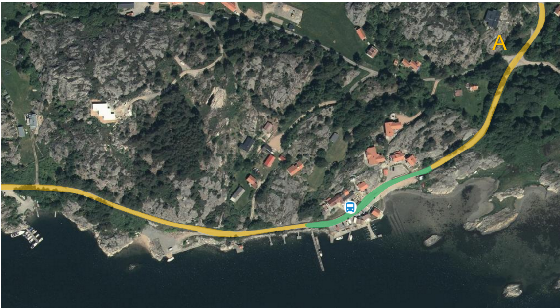
Figur 6 Föreslagen skyltad hastighet. Gult område representerar 50 km/h och grönt 30 km/h. (Bilden är hämtad från Hitta.se)
